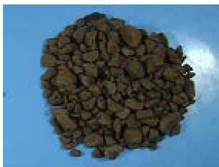
解説 写真-1.2 軽量粗骨材 (頁岩系非造粒形, 最大寸法 15mm)
