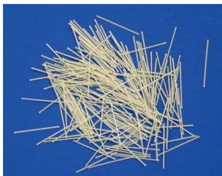
解説 写真-1.1 PVA 短繊維 (直径 0.66 mm, 長さ 30 mm)
