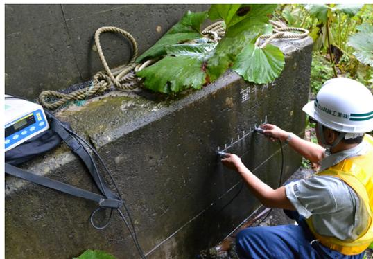
写真-3 測定状況（左手が発振子、右手が受振子）
