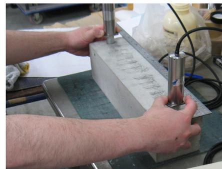
写真-1 表面走査法による測定状況
