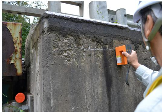
写真-2 表面水分率の測定
