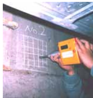
写真 4.5 シュミットハンマーによる反発硬度の測定
