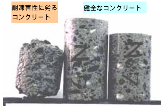
写真 4.12 円形の採取コアによる凍結融解試験の例
