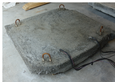
凍結融解試験による 劣化損傷試験体
