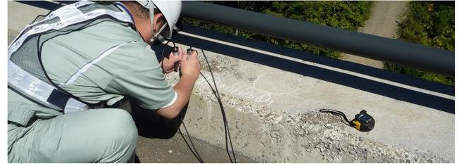
表面走査法による凍害点検状況
