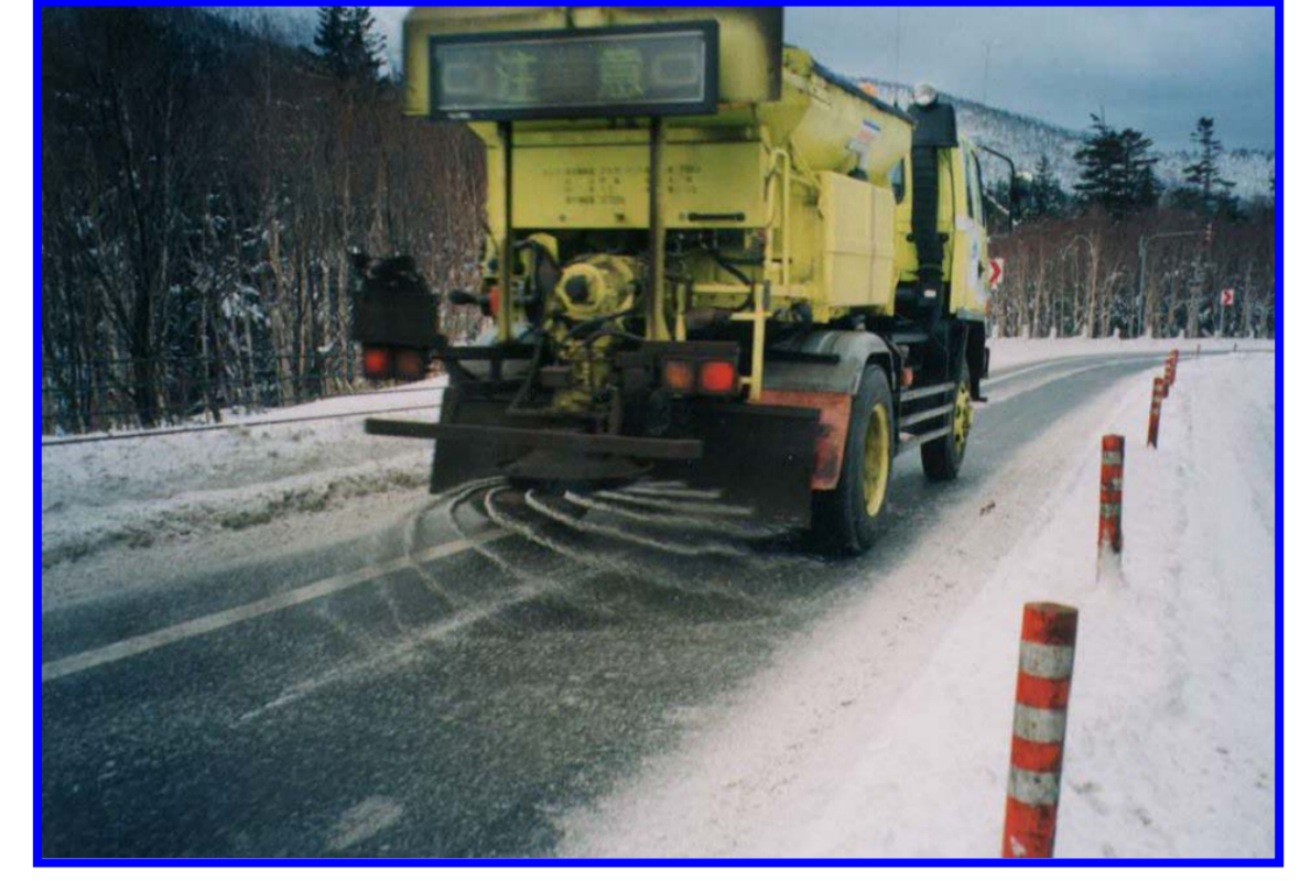
写真(左) 表面が雪氷で覆われた日本海沿岸の覆道 写真(右) 凍結防止剤の散布状況(内陸でも塩害が懸念される)
