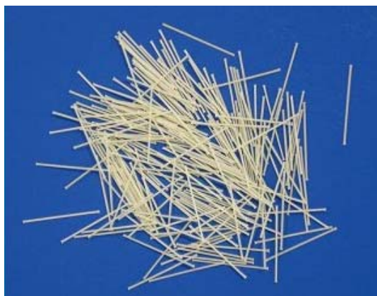
解説 写真-2.2 PVA 短繊維 (直径 0.66 mm, 長さ 30 mm)
