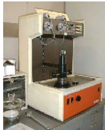
写真 4.9 水銀圧入測定装置 (例)
