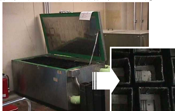
写真 4.10 凍結融解試験装置
