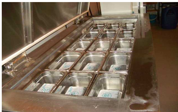
写真 4.14 CDF 試験の凍結融解試験機
